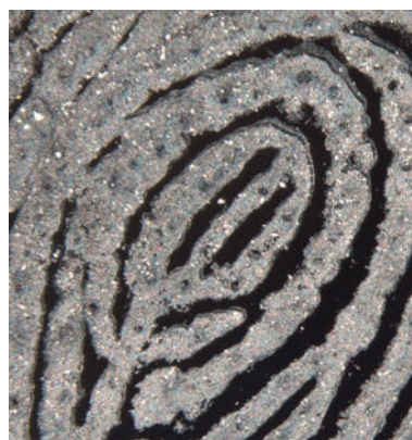
Leica LED5000 MCI : Empreinte digitale sur un CD en éclairage oblique
