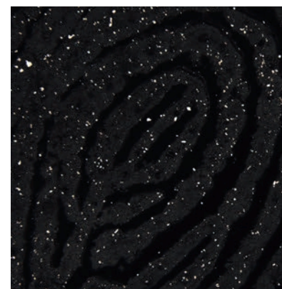
Leica LED5000 MCI : Le même échantillon en lumière épiscopique rasante. Les particules de poussière sont particulièrement visibles
