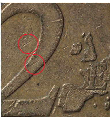
Leica LED3000 MCI : L'arc d'éclairage gauche permet de voir des éraflures d'orientations différentes
