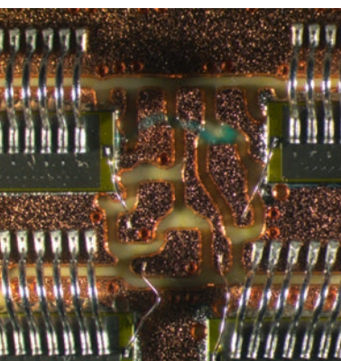
Leica LED3000 SLI : Les câbles de connexion de la carte électronique sont mis en évidence par une lumière latérale
